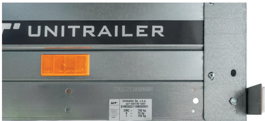
Obr. 1. Umístění výrobního štítku přívěsu.
