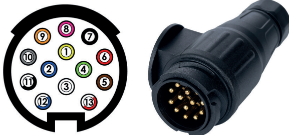
Schéma 2. Schéma elektroinstalace – 13-pólová zástrčka
